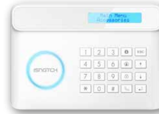
Pannello centrale d'allarme
