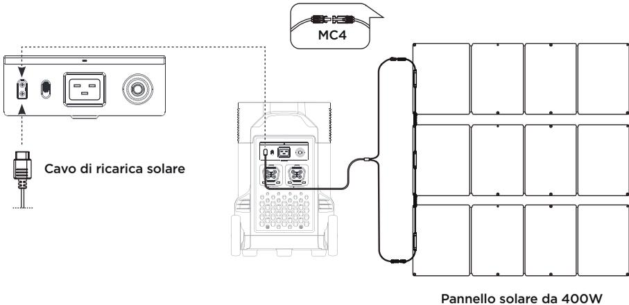
\*Cavo di ricarica solare (cavo adattatore MC4-XT60) fornito separatamente.
