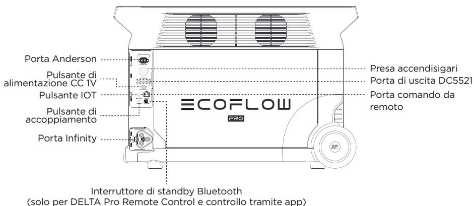
\*Interruttore di standby Bluetooth: una volta attivato l'interruttore di standby Bluetooth, il modulo Bluetooth continuerà a funzionare anche se DELTA Pro è spento. Gli utenti possono attivare/disattivare DELTA Pro in remoto tramite il telecomando (venduto separatamente) o l'app EcoFlow. La funzione di standby Bluetooth consuma un po' di energia, quindi spegnila quando non la usi.
