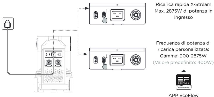
È possibile regolare la potenza di ricarica tramite l'interruttore di velocità della ricarica CA situato sul retro del prodotto. È possibile impostare la gamma di potenza di ricarica nell'applicazione EcoFlow. Utilizzare il cavo CA EcoFlow per la ricarica rapida. EcoFlow non si assume alcuna responsabilità per eventuali conseguenze derivanti dal mancato rispetto delle istruzioni, inclusa a titolo esemplificativo ma non esaustivo, la ricarica con un cavo di ricarica CA di terze parti.
